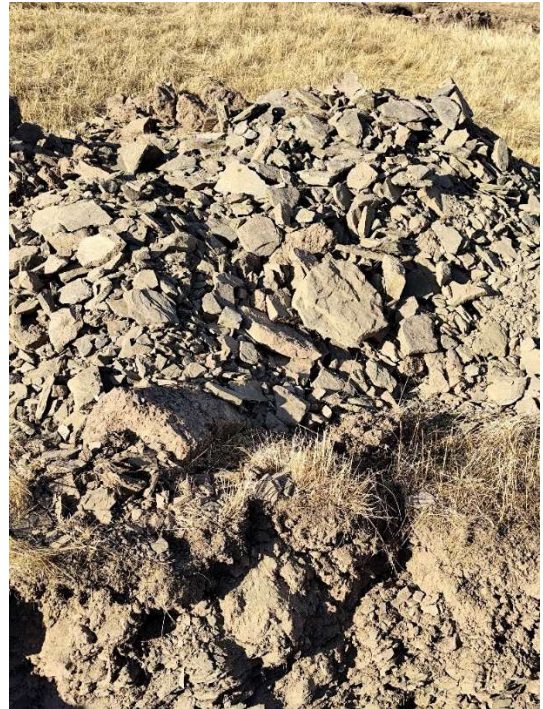
↑ Abb. 4: plattiger Zerfall des tieferen Tonsteins beim Ausheben
