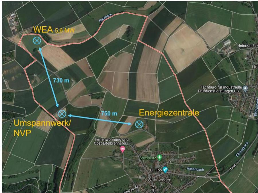
Abbildung 7-9: Direkte Entfernungen zwischen Windenergieanlage, Umspannwerk und Energiezentrale.
