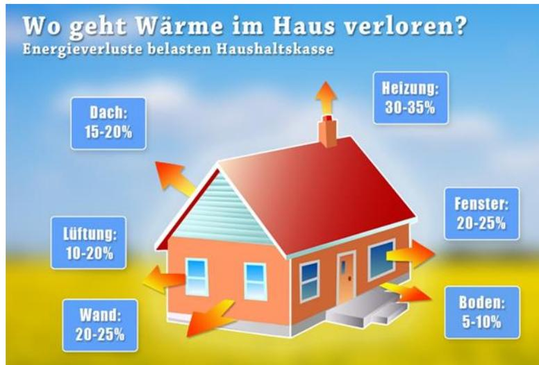
Abbildung 3-2: Energieverluste bei der Wärmeversorgung bestehender Wohngebäude<sup>25</sup>
